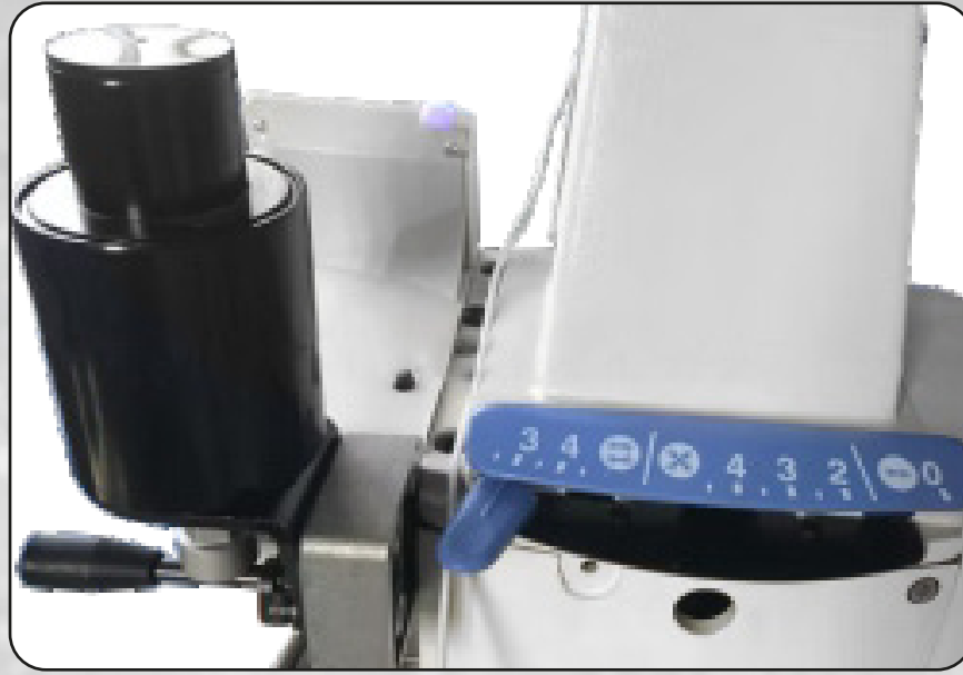
LEVANTA PRENSATELAS AUTOMÁTICO, AYUDA A AGILIZAR EL PROCESO DE TRABAJO
