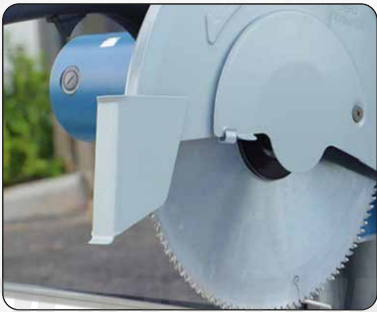
PROTECTOR DE SEGURIDAD PARA CORTES MÁS SEGURO
